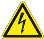
W08 Warnung vor gefährlicher elektrischer Spannung
